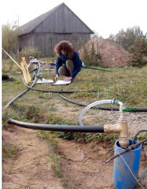
9 pav. Gręžinių hidrogeologinis išbandymas ir mėginių paėmimas. N. Šeirio nuotr.
