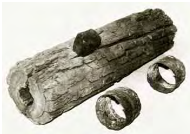
Medinis Vilniaus vandentiekio vamzdis ir metalinės sujungimo movos, medinis kamštis orui išleisti (XVII a.) (iš Senasis..., 2000 m.).
